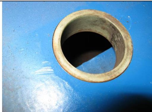
Der Bolzen zeigt nach drei Jahren keinen Verschleiß. Es ist an der Oberfläche die Bearbeitung durch Drehen erkennbar.
